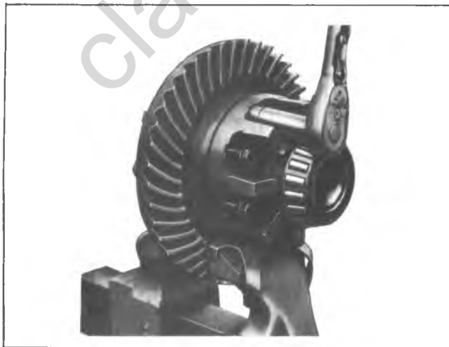
Fig. 3F--Separating Case Halves
