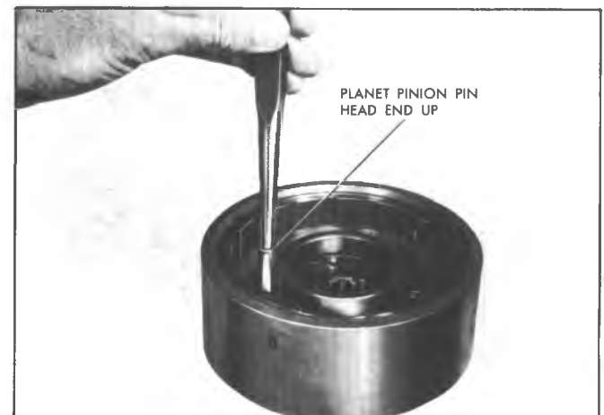
Fig. 7A-132C--Installing Planet Pinion Pin
