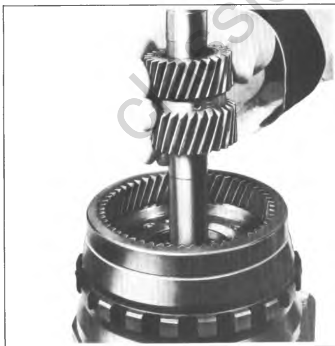
Fig. 7A-49C--Removing Sun Gear
