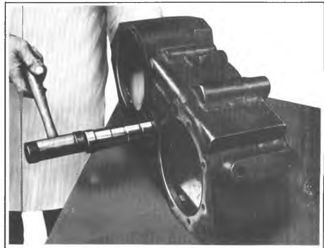
Fig. 7E-13R--Installing Idler Shaft
