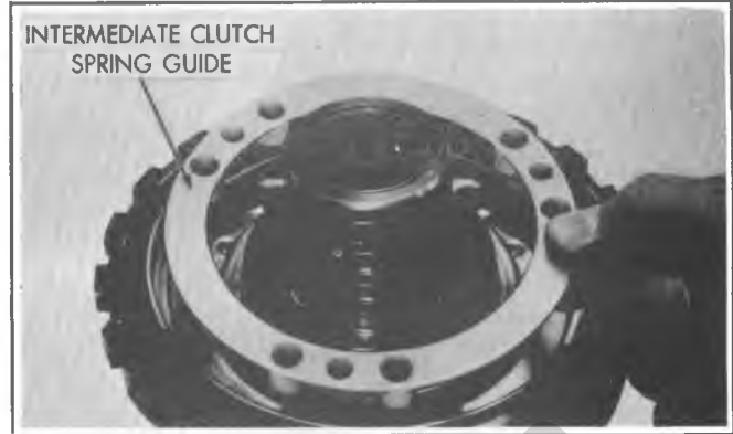
Figure400-81 Installing Spring Guide
