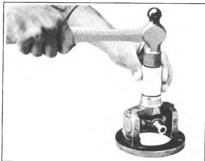
Fig. 4A-31—Installing Centering Ball Seal
