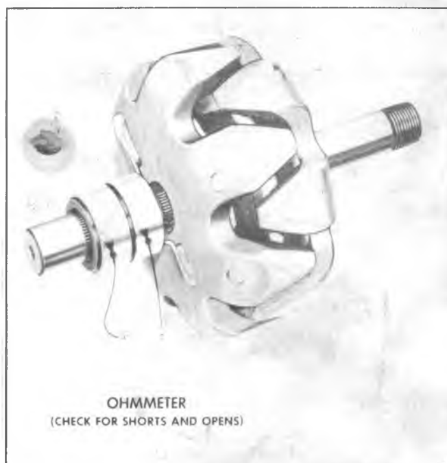
Fig. 6D-8C--Checking Rotor
