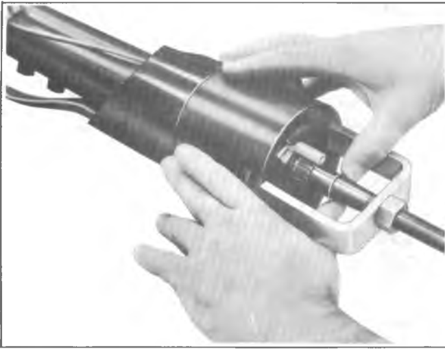
Fig. 3B4-30—Installing Snap Ring
