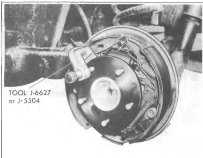
Fig. 4B-23--Pressing Out Wheel Stud
