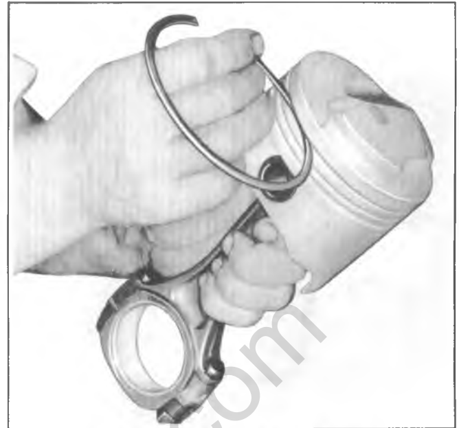
Fig. 6A5-55--Checking Ring in Groove
