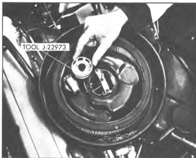
Fig. 76—Damper Door Thermometer Reading
