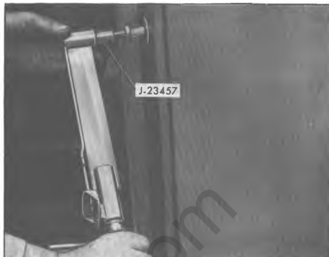
Fig. 13G—Loosening Striker Bolt
