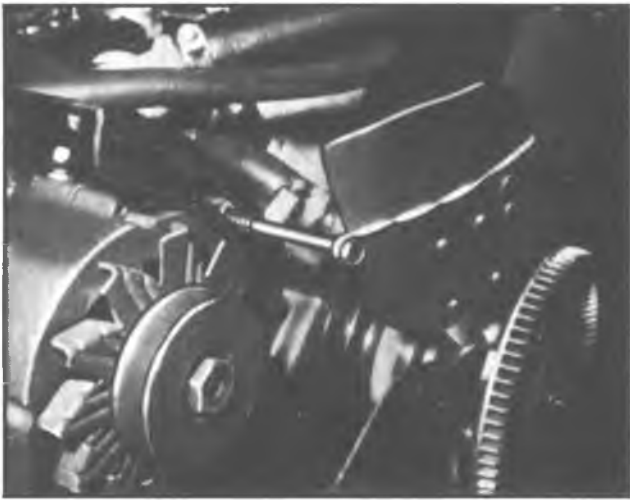
Fig. 12—Securing Fan Blade
