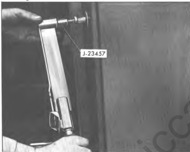
Fig. 23—Loosening Striker Bolt
